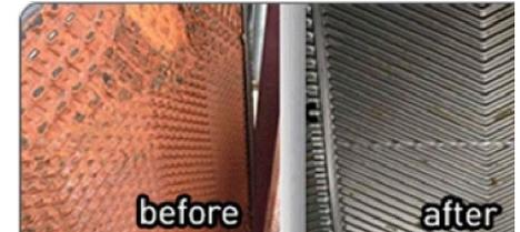
La formación de escamas puede tener varias consecuencias negativas en su sistema. Entre ellas se encuentran la reducción de la eficiencia de transferencia de calor, el aumento de la presión del sistema el mayor consumo de energía y el impedimento del flujo. Es importante tomar medidas para prevenir la formación de escamas y mantener su sistema en óptimas condiciones.
